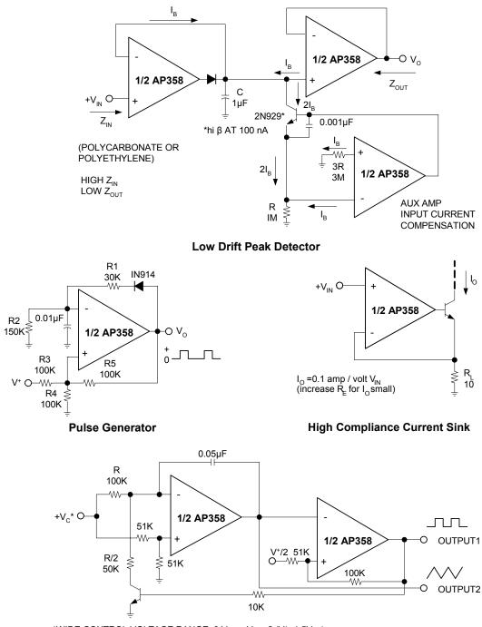
\*WIDE CONTROL VOLTAGE RANGE: 0  $V_{DC} \le V_C \le 2 (V^+ - 1.5V_{DC})$
